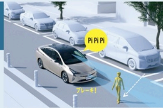
●プリクラッシュセーフティシステム(歩行者検知機能付衝突回避支援タイプ)の作動イメージ
